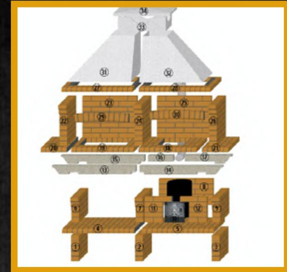
Печи-барбекю поставляются в виде комплекта деталей для сборки в соответствии с прилагаемыми схемами. Детали пронумерованы для облегчения сборки. Монтажные смеси поставляются в комплекте с деталями сборки. Более подробная инструкция по сборке печей содержится в руководстве по монтажу.
